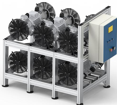
L'unité centralisée CENTRALAIR 6 est un compresseur sec d'un débit de 2 700 l/min à 5 bar et d'une pression maximale réglable de 8 à 10 bar. L'unité de contrôle est capable de réguler le fonctionnement des éléments de pompage de manière à garantir une pression constante au système.
