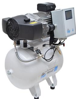
Compresseur d'air sec version IOT, 2 cylindres, avec un débit d'air de 170 l/min à 5 bar de pression. Réservoir d'une capacité de 40 L, traitement de surface interne contre la corrosion.
