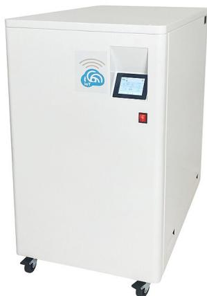
Compresseur d'air sec version IOT, 3 cylindres, avec un débit d'air de 250 l/min à 5 bar de pression. Réservoir d'une capacité de 40 L, traitement de surface interne contre la corrosion.
