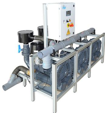
Système d'aspiration à sec centralisé pour 60 unités en fonctionnement simultané, composé de 3 unités d'aspiration ASPIR 8 16,5 kW. centrale avec PLC pour l'activation automatique des pompes à seuil de vide, complète avec capteur de pression, régulation, alarmes, inverseur. Puissance totale triphasée à 50 Hz, 16,5 kW 400V, débit maximum de 18 000 l/min, à une hauteur manométrique maximum pour un service continu de 160 mbar. Système complet de 3 filtres antibactériens HEPA.
