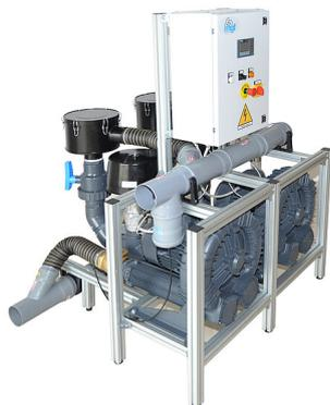
Système d'aspiration à sec centralisé pour 40 unités en fonctionnement simultané, composé de 2 unités d'aspiration ASPIR 8 de 5,5 kW chacune, unité de commande avec PLC pour l'activation automatique des pompes à seuil de vide, complet avec capteur de pression, régulation, alarmes. Puissance totale de sortie triphasée à 50 Hz, 11 kW 400V, débit maximum de 12.000 l/min, à une hauteur manométrique maximum pour un service continu de 160 mbar. Système complet de 2 filtres antibactériens HEPA
