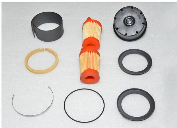
Le kit de pièces détachées d'entretien extraordinaire GENESI comprend : un filtre d'aspiration, deux bagues élastiques, des joints toriques, une cartouche filtrante de ligne et deux plaques à clapets complètes. Les intervalles d'entretien recommandés pour ce compresseur sont de 1 500 heures / 2 ans. Les opérations de maintenance peuvent être effectuées à une fréquence plus élevée si l'environnement dans lequel fonctionne le compresseur est particulièrement sale.
