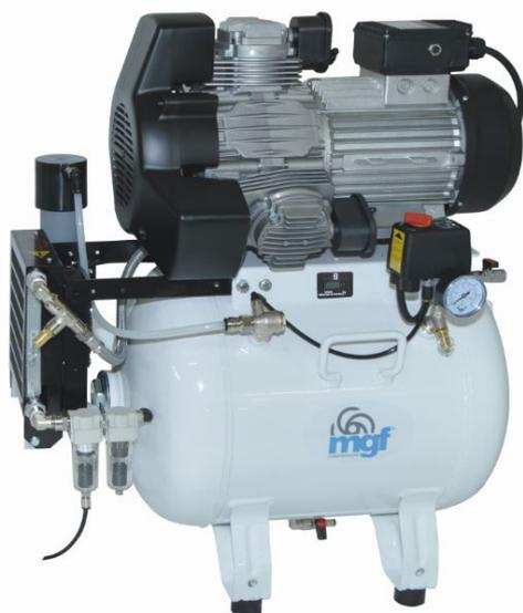
Compresseur d'air sec, 3 cylindres, avec un débit d'air comprimé de 225 l/min à une pression de 5 bars. Capacité du réservoir 40 L, traitement de surface interne pour protéger contre la corrosion.
