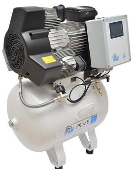
Compresseur d'air sec version IOT, 3 cylindres, avec un débit d'air comprimé de 250 l/min à 5 bars de pression. Capacité du réservoir 40 L, traitement de la surface interne pour protéger contre la corrosion.
