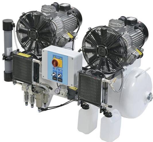
Compresseur sec triphasé pour cycle de travail intensif, 6 cylindres, débit d'air 350 l/min@8 bar, réservoir de 90 litres, sécheur à membrane de nouvelle génération capable de fournir de l'air séché jusqu'à -20°C de point de rosée.
